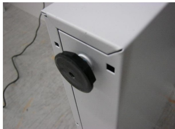
Figuur 10: Beproefd exemplaar 170610-3 van Voortman Hi Tee zit/statafel op wangen - detail stelvoet.
