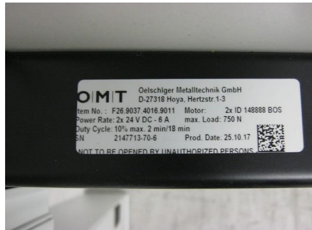
Figuur 8: Beproefd exemplaar 170610-3 van Voortman Hi Tee zit/statafel op wangen - detail onderaanzicht regelunit voor de verstelling.
