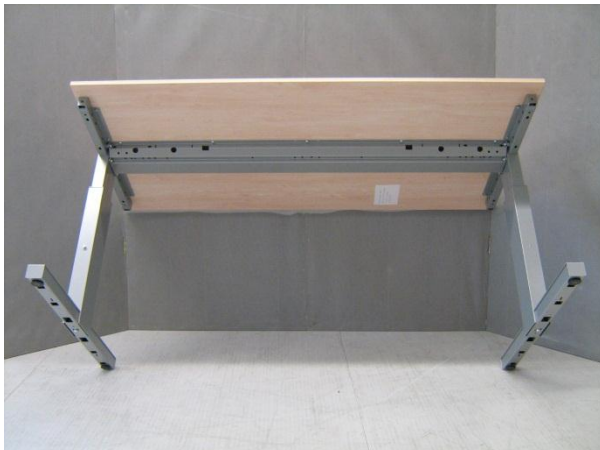
Figuur 3: Beproefd exemplaar 12.0866-3 van Voortman Hi Tee bureautafel, hoogte instelbaar- onderaanzicht
