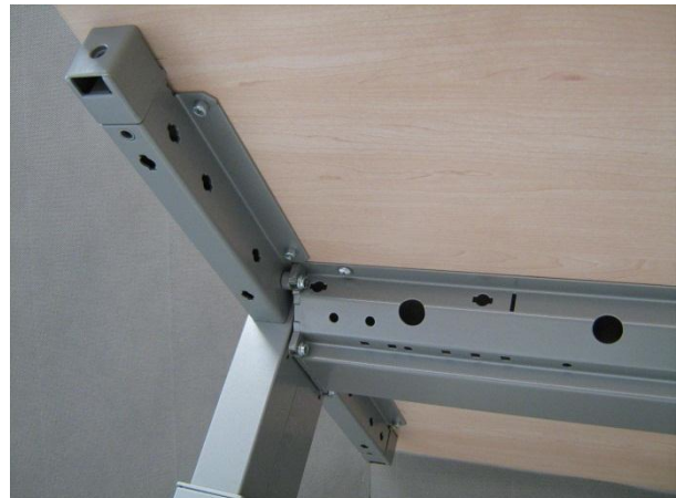
Figuur 4: Beproefd exemplaar 12.0866-3 van Voortman Hi Tee bureautafel, hoogte instelbaar- detail bevestiging poot aan traverse
