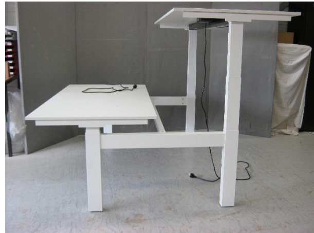
Figuur 2: Beproefd exemplaar 170610-1 van Voortman Hi Tee Duo dubbele zit/statafel op poten - zijaanzicht linker blad in laagste stand, rechterblad in hoogste stand.
