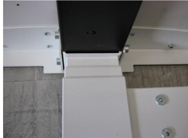
Figuur 6: Beproeft exemplaar 170610-1 van Voortman Hi Tee Duo dubbele zit/statafel op poten - bevestiging horizontale deel en de poot.
