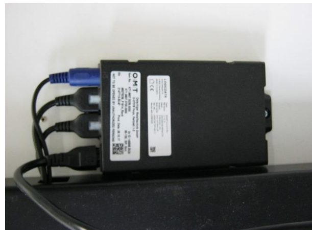
Figuur 8: Beproeft exemplaar 170610-1 van Voortman Hi Tee Duo dubbele zit/statafel op poten - detail onderaanzicht regelunit voor de verstelling.
