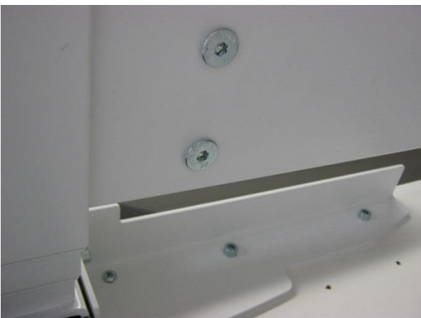
Figuur 9: Beproeft exemplaar 170610-1 van Voortman Hi Tee Duo dubbele zit/statafel op poten - onderaanzicht detail montage poot.
