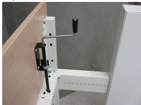
Figuur 6: Beproefd exemplaar 12.0866-1 van Voortman Hi Tee wangen bureautafel, slingerverstelbaar- detail hoogte verstelling
