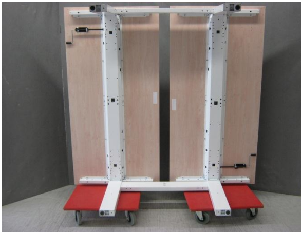
Figuur 5: Beproefd exemplaar 12.0866-2 van Voortman Hi Tee duo open werkplek, slingerverstelbaar- onderaanzicht
