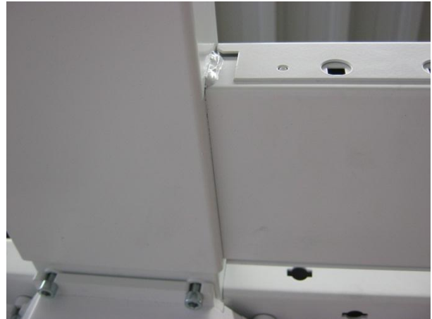
Figuur 8: Beproefd exemplaar 12.0866-2 van Voortman Hi Tee duo open werkplek, slingerverstelbaar- detail verbinding poot aan dwarsligger die de verbinding vormt naar de andere poot
