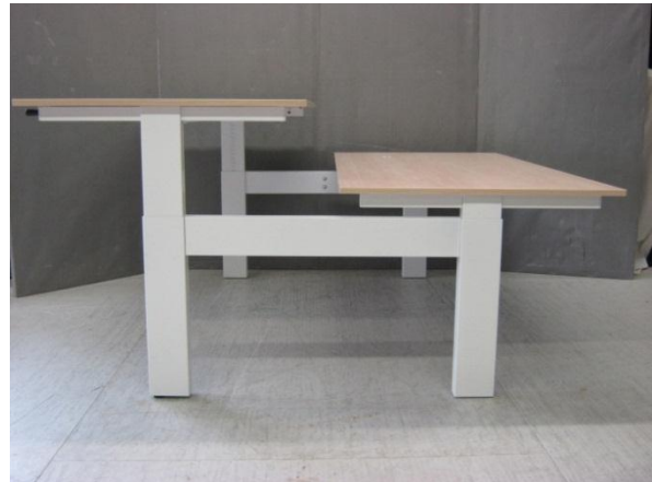
Figuur 4: Beproefd exemplaar 12.0866-2 van Voortman Hi Tee duo open werkplek, slingerverstelbaar- – hoogste stand zij-aanzicht
